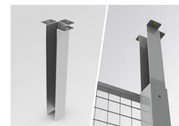
10 TOPPFÄSTE 80x80 Används för att fästa höga väggar i tak. Har en teleskopkonstruktion som tillåter strukturella rörelser.
