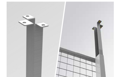
6 TOPPFÄSTE 60x40 Används för att fästa höga väggar i tak. Har en teleskopkonstruktion som tillåter strukturella rörelser.
